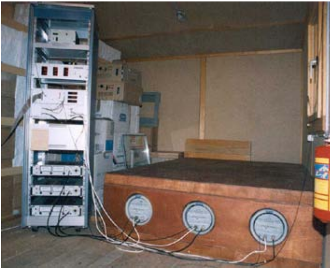
Figura 5 - Monitor di neutroni di tipo NM64 all'Osservatorio Sphinx dello Jungfrauoch (in Svizzera) a 3500 m di quota (cortesia Rolf Bütikofer e Erwin O. Flückiger).
